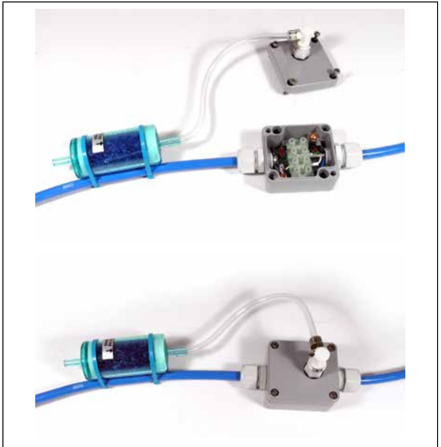
Fig. 7-9 Élément de compensation de pression installée
